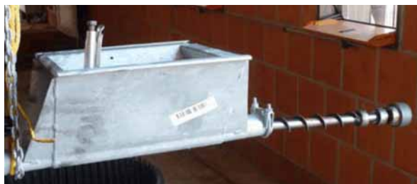
Figura 6-6: Spirala la axul de tensionare
