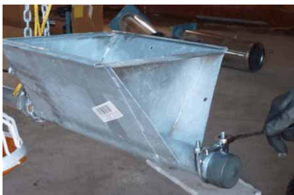
Figura 6-9: Fixarea axului de tensionare
