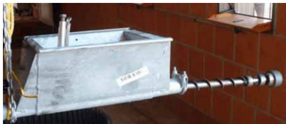
Figura 6-4: Fixarea spiralei cu cleștele de prindere
