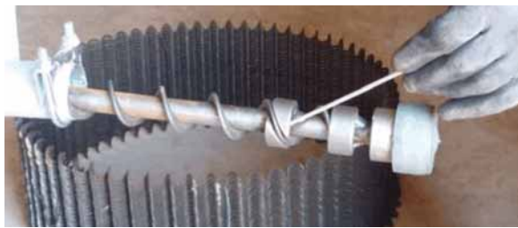
Figura 6-5: Desfacerea spiralei de pe axul de tensionare
