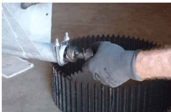
Figura 6-8: Ținerea fermă a axului de tensionare
