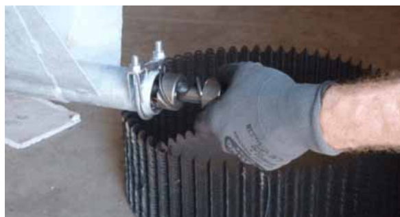
Figura 6-3: Extragerea axului de tensionare
