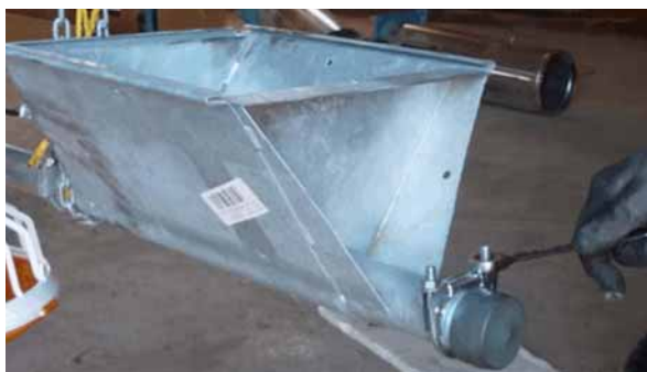
Figura 6-2: Desfacerea etrierului în formă de U
